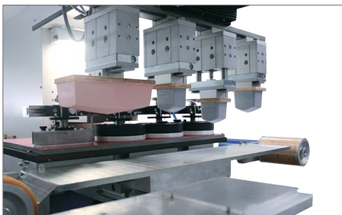
Tamponiarka TPX 550 ze stołem przesuwającym i parawanem zabezpieczającym z kurtyną świetlną TPX 550 with shuttle table and safety guarding with light curtain
