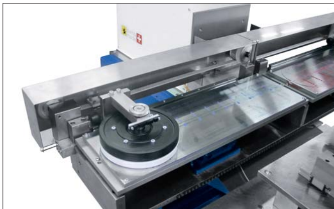
Tamponiarka TPX 550 ze stołem przesuwającym i parawanem zabezpieczającym z kurtyną świetlną TPX 550 with shuttle table and safety guarding with light curtain
