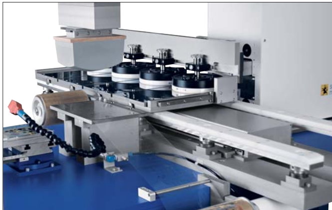
Tamponiarka TPX 550 – druk 6-kolorowy – z karuzelą przenośnikową i urządzeniem do czyszczenia tamponu TPX 550 – 6 colour print – with Transfert Carre and pad cleaning device
