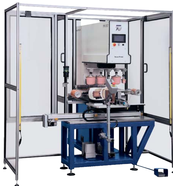
Tamponiarka TPX 552 – druk 2-kolorowy – z mechanizmem farbowym z bocznym kałamarzem TPX 552 – 2 colour print – and lateral cup inking mechanism
