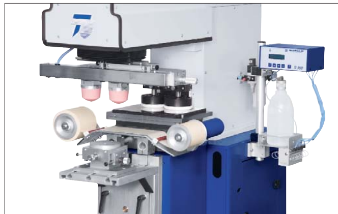
Stół przesuwany VT 602 i stół krzyżowy KT 50 na tamponiarce TPX 200 Shuttle table VT 602 and coordinate table KT 50 on a TPX 200
