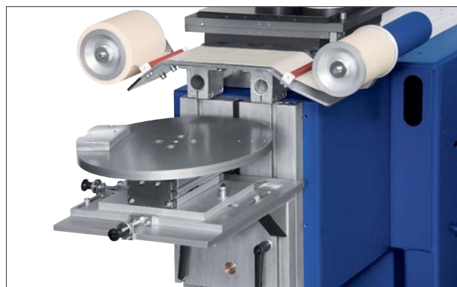
Stół przesuwany VT 602 i stół krzyżowy KT 50 na tamponiarce TPX 200 Shuttle table VT 602 and coordinate table KT 50 on a TPX 200
