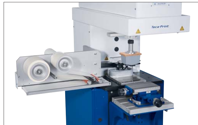
Urządzenie przesuwające tampon i karuzela przenośnikowa TFC-i 125 na tamponiarce TPE 251 do druku 4-kolorowego
