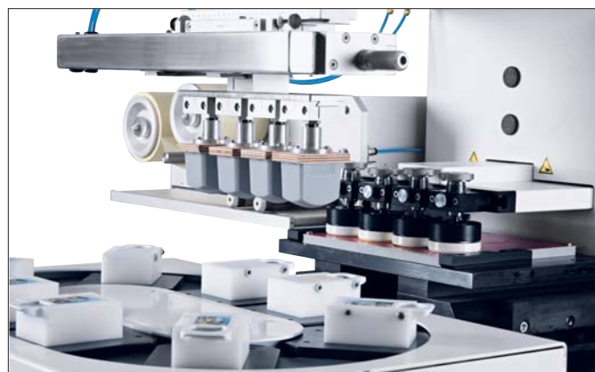
Tamponiarka TPE 250 na podstawie MS 250, wyposażona w stół przesuwany VTP, stół krzyżowy KT 30 i stół kątowy
